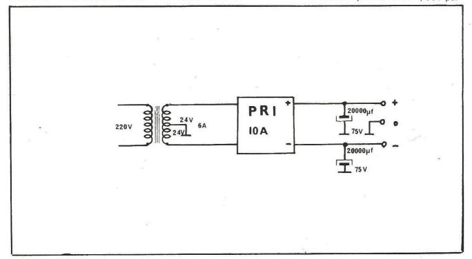
ejemplo) si el rizado supera los 40V provocará que actuen las protecciones internas del integrado y se desconecte la salida del mismo.
